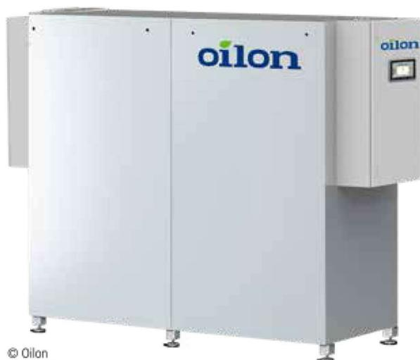
Industrielle Wärmepumpen der Serie Oilon ChillHeat S180 - S580 liefern eine hohe Leistung bei kompakter Größe. Sie eignen sich gleichermaßen gut für die Wasserkühlung und Heizung. Die Ausstattung mit energieeffizienten und kompakten Schraubenverdichtern und Plattenwärmetauschern ist eine bewährte Lösung, dank derer die Pumpen Temperaturen bis zu +85 °C mit einem guten COP erzeugen können.
